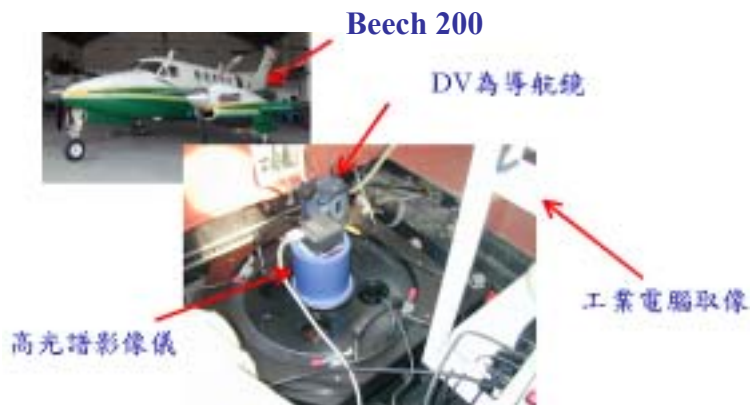
圖 3. 空載實驗飛機 Beech200 及高光譜影像儀裝置
