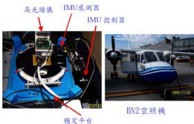
圖三. 高光譜影像儀裝置及空載實驗飛機 BN2
